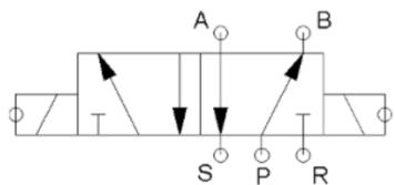
در حالت عادی مسیر دهانه فشار به دهانه سیگنال B باز می باشد و هوای دهانه سیگنال A از طریق دهانه خروجی S تخلیه می شود. در صورتیکه شیر از سمت چپ تحریک شود، دهانه خروجی S بسته شده و مسیر دهانه فشار به سمت دهانه سیگنال A تغییر می کند که در این حالت هوای دهانه سیگنال B از طریق دهانه خروجی R تخلیه می شود.
