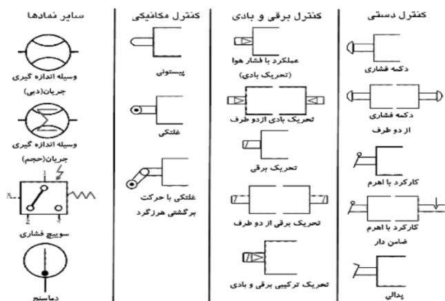
**شیرهای پنوماتیکی** : شیرهای پنوماتیکی را می توان بر اساس کار کرد آنها در رابطه با نوع سیگنال دهی، نحوه کار اندازی و ساختار تقسیم بندی نمود .
