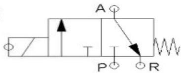
در حالت عادی مسیر دهانه فشار به دهانه سیگنال بسته است. در صورتیکه شیر توسط جریان برق تحریک شود مسیر P به A باز میشود و دهانه خروجی R بسته میشود. این حالت تا زمانیکه تحریک ادامه دارد، باقی می ماند. زمانیکه تحریک قطع شود، نیروی فنر شیر را به وضعیت اول بر می گرداند.
