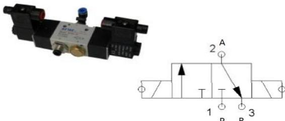
در حالت عادی دهانه فشار بسته بوده و مسیر دهانه سیگنال 2 به دهانه خروجی 3 باز است. با تحریک شیر از سمت چپ، مسیر دهانه فشار به دهانه 2 یا دهانه سیگنال، باز می شود و دهانه خروجی 3 بسته می شود.
